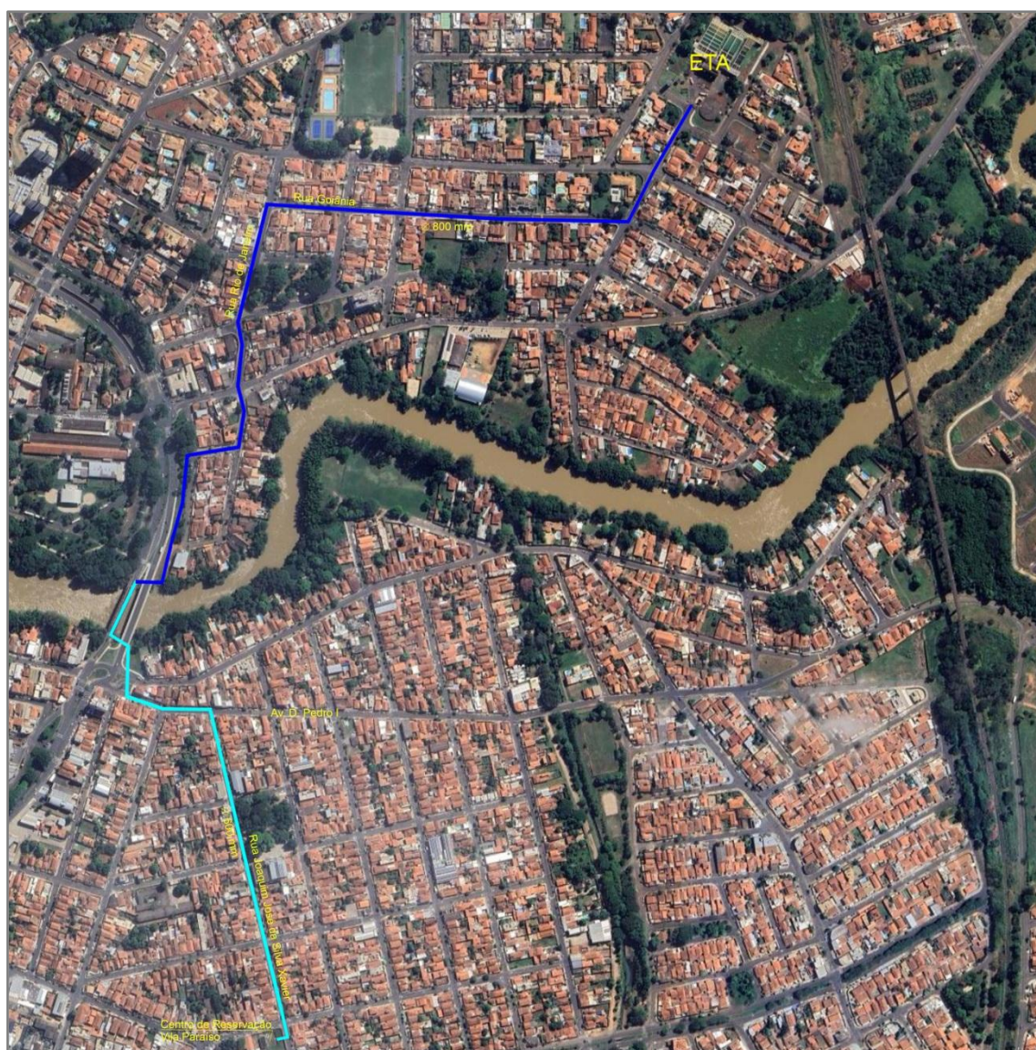
Figura 1 – Caminhamento da nova adutora de água tratada ETA-Vila Paraíso.
